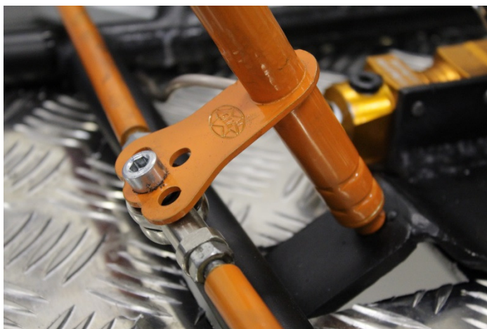
Slika 12: Del krmilnega mehanizma
