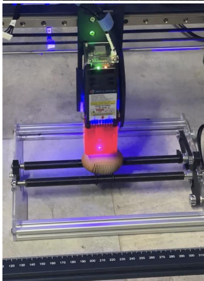
Slika 34: Graviranje jajca z valjčki in izdelek
