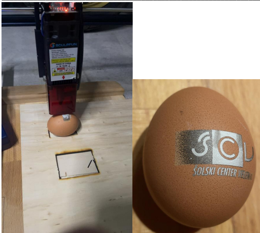
Slika 32: Graviranje jajca brez rotacije in izdelek
