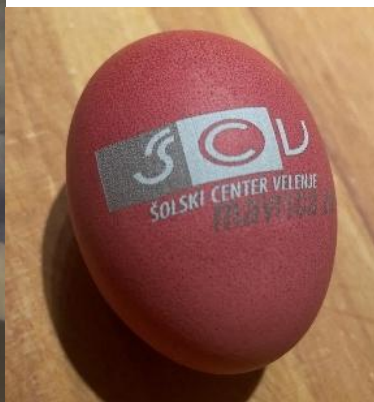
Slika 36: Graviranje jajca z vpetjem v najino napravo in izdelek
