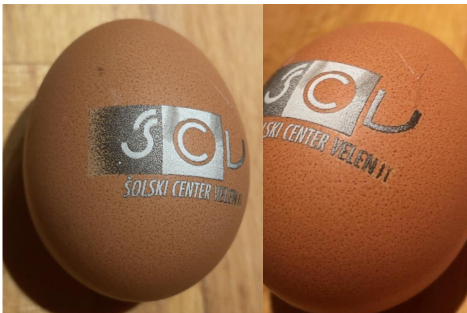
Slika 38: Graviranje brez rotacije (opazimo megleno gravuro)
