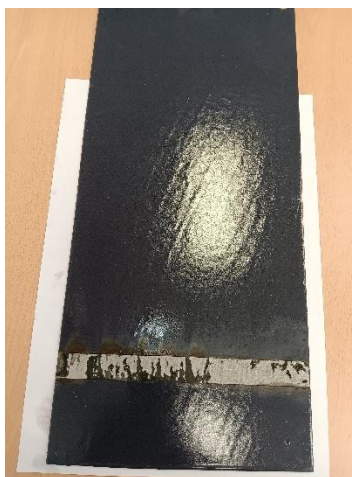
Slika 9: Emajlirana plošča, zaščiteni proti koroziji
