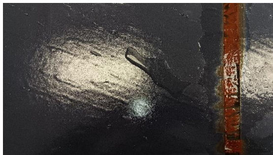
Slika 10: Emajlirana plošča, nezaščiten proti koroziji
