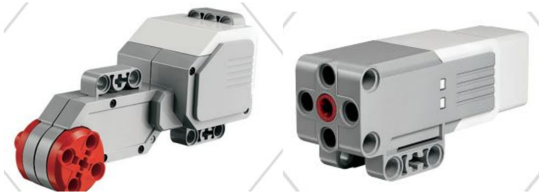
Slika 9: Lego EV3 velik motor (levo) in srednji motor (desno).
